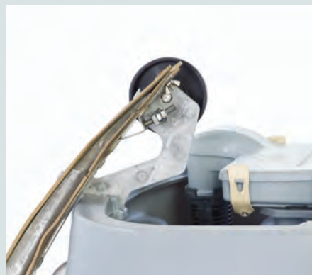
Inbyggt system för upphängning av sugskrapa på smutsvattentanken för enkel genomfart i trånga utrymmen.
