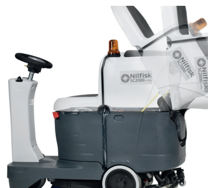
Smutsvattenstanken kan vippas, så att man lätt får tillgång till batterirum och Ecoflex-systemet.
